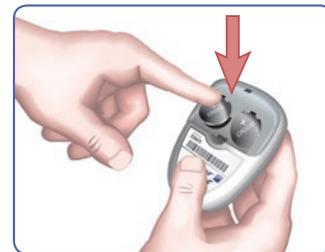
4. Dans le compartiment prévu à cet effet, placez les piles neuves sous les ergots avec le « + » orienté vers le haut.
