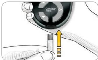
3. Introduire l'extrémité grise de la bandelette réactive dans le port d'insertion du lecteur et attendre le signal sonore.
