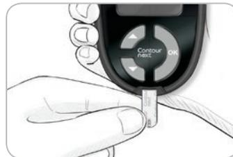
3. Insérer l'extrémité grise de la bandelette réactive dans le port d'insertion du lecteur. Celui-ci émet un signal sonore.
