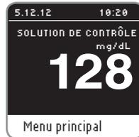
10. Le lecteur décompte 5 secondes et affiche le résultat du test de contrôle qui est automatiquement marqué « SOLUTION DE CONTRÔLE » et gardé en mémoire. Les résultats du test de contrôle ne sont pas inclus dans les moyennes de la glycémie.
